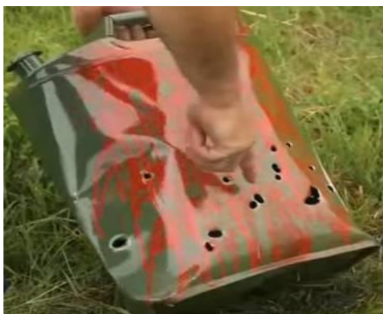
Рисунок 3 – Пробоины от выстрелов 7,62-мм пулемета Калашникова в железной канистре, ранее заполненной бензином
