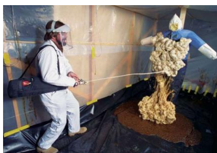
Рисунок 4 – Пистолет с клейкой пеной
